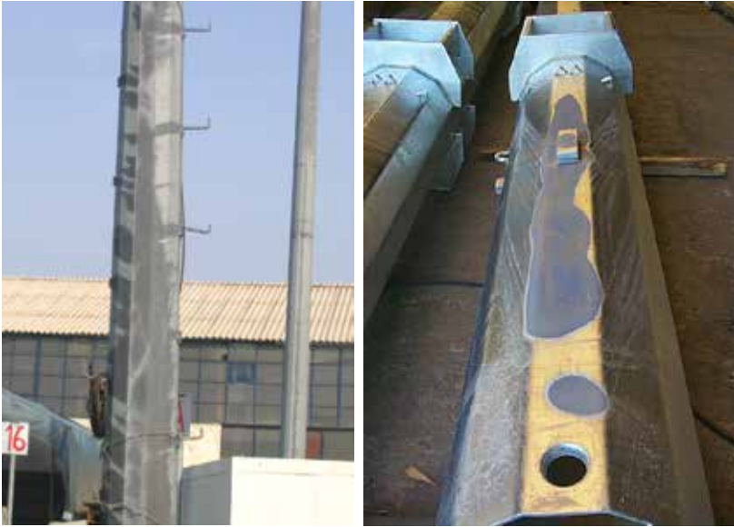
Resim 7 - Mat Renkli Galvaniz Yüzeyi
