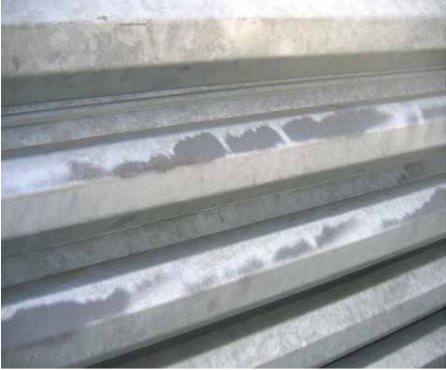
Resim 8 - Mat Renkli Galvanizli Yüzeyler
