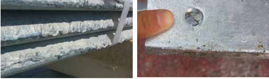
Resim 14 - Kenarlarda ve deliklerde galvaniz birikintileri
