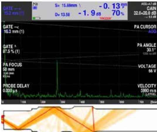
Şekil 14. 30° prop ile ultrasonik muayene görüntüsü ve şematik gösterimi.
