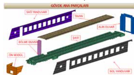
RESİM -1: ALÜMİNYUM GÖVDE ANA PARÇALARI
