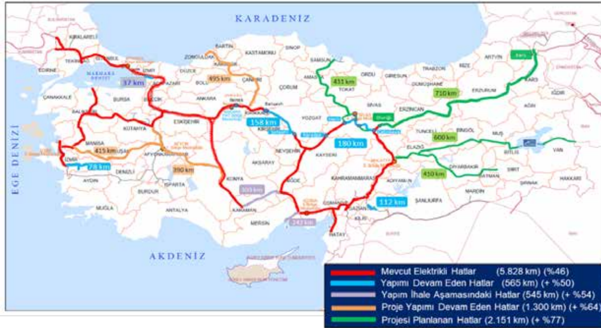
Şekil 52. Demiryolu Ana Hatlarında Elektrifikasyon Çalışmaları
