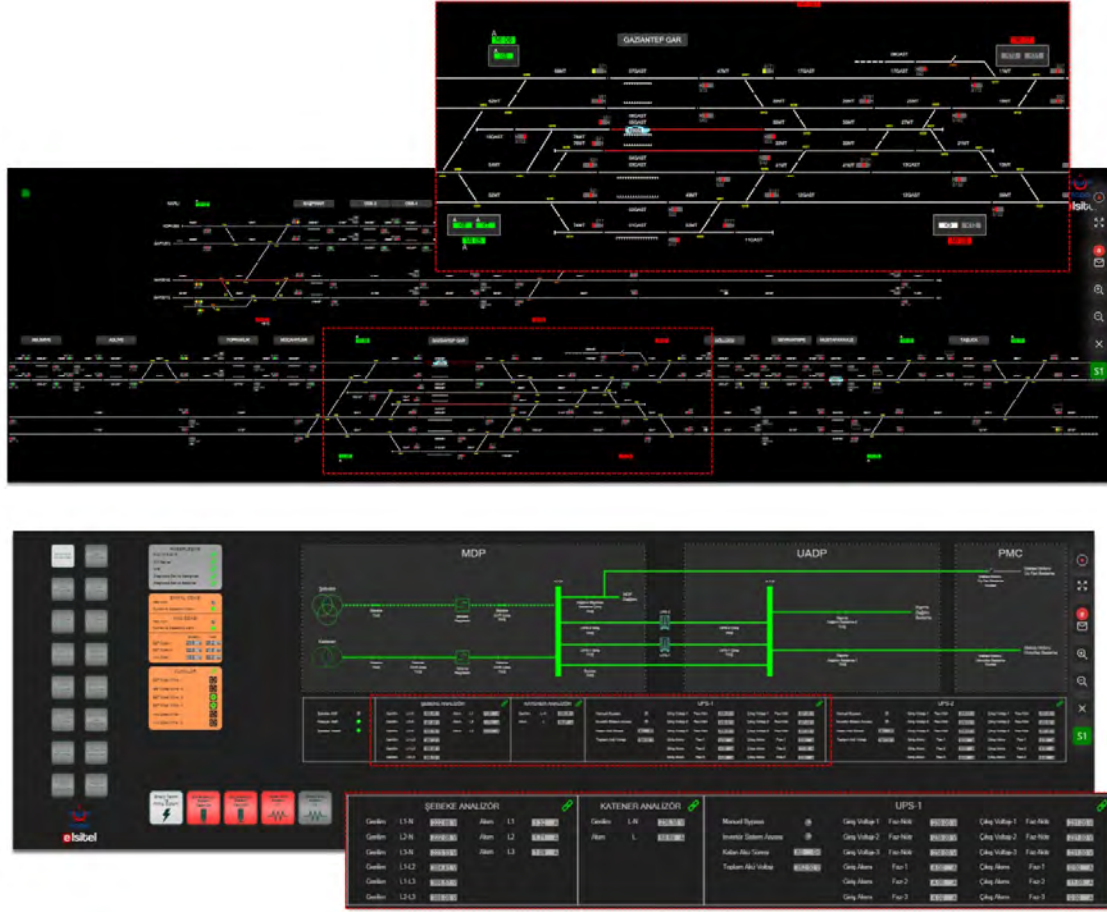
Şekil 2: Uzaktan İzleme, Yönetim ve Denetim Sistemi (e-SCADA)
